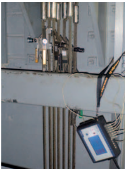
Bild 9: Messung der Seilspannung im Seilset
