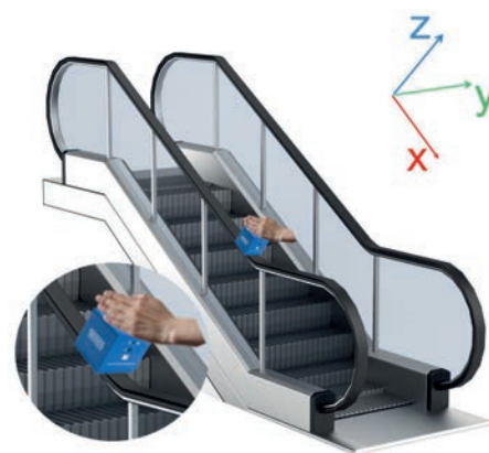
Ausrichtung und Positionierung des Vibrationssensors auf den Handläufen
